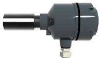
为了便于用户的维护、检修和产品更换，检测器信号输出采用电流信号输出方式。电源使用 24VDC 电源，接线方式为内部接线方式。检测器使用对数放大器进行信号的处理，前端电路既可以保证火焰亮度与信号强度的线性增益关系，又可以防止电流信号饱和情况的发生。
